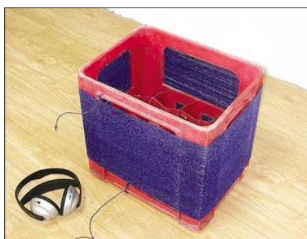
Auch eine praktische Idee: die Getränkebox als Spulenkörper.
