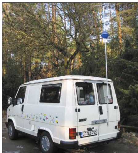
Bild 5: Verlängerte Mobilantenne am Wohnmobil Fotos: DJ6HP (4)
