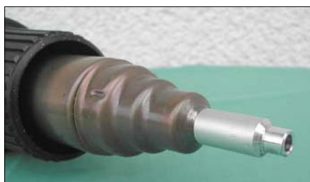
Abb. 2: Heißluftpistole mit aufgesetzter 5-mm-Düse
