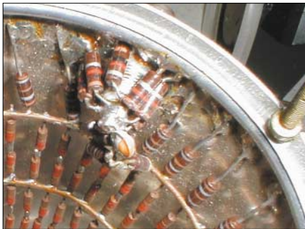
Bild 7: Detailansicht der Auskopplung am Widerstandskegel
