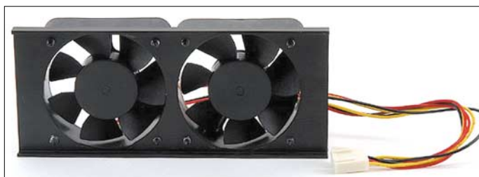
Schwer verzichtbares Zubehör bei der Nutzung mit lang dauern dem Oberstrichbetrieb wie SSTV, RTTY oder FM: der auf den Kühlkörper aufschraubbare Doppellüfter, Modell 308. Der Stecker ist innen im Gerät aufzustecken.
