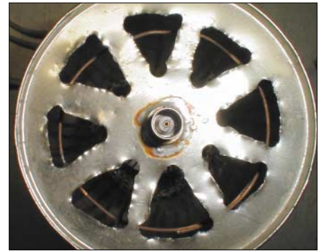
Bild 9: Draufsicht auf den Leistungsteiler, mit Eingangsbuchse und Lüftungslöchern
