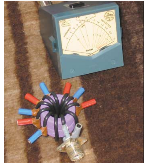
Bild 4: Spartransformator zur Antennenanpassung
