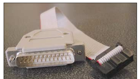
Bild 4: Der MSP430-JTAG-Adapter wird mit dem Centronics-Port des PC verbunden.
